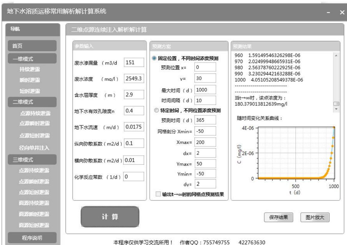
图 5.2-6 沼气池泄露 COD 对地下水影响计算结果 (30m)
