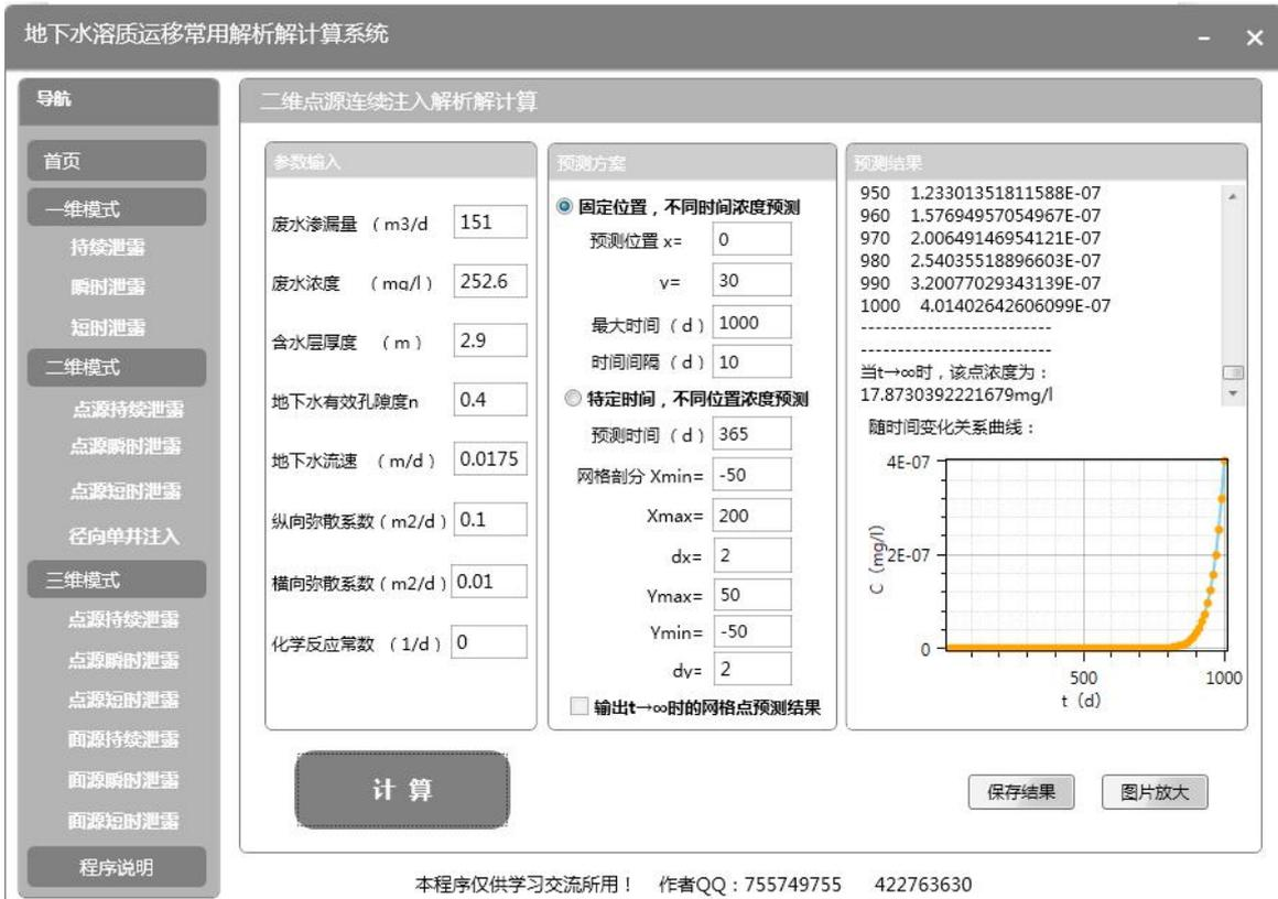
图 5.2-9 沼气池泄露 NH<sub>3</sub>-N 对地下水影响计算结果 (30m)
