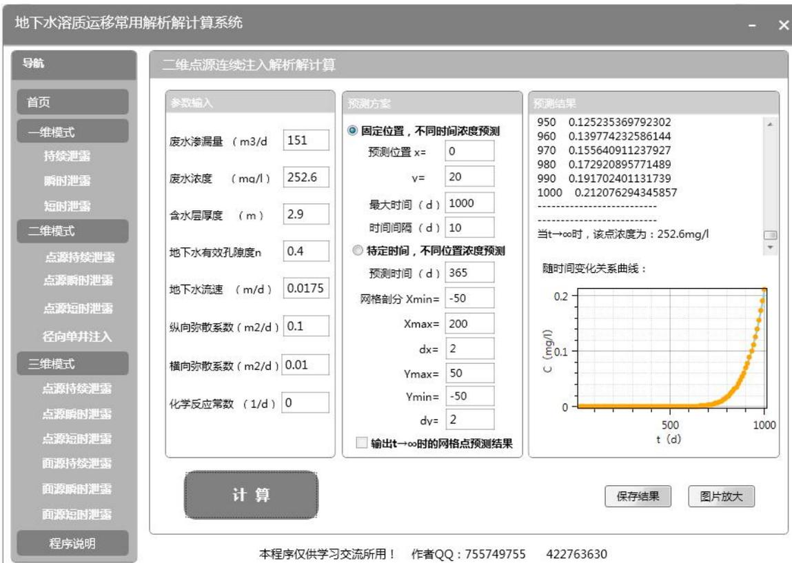
图 5.2-8 沼气池泄露 NH<sub>3</sub>-N 对地下水影响计算结果 (20m)
