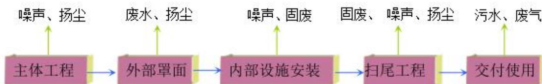
图 3.1-1 建设项目施工期工艺流程及排污节点图
