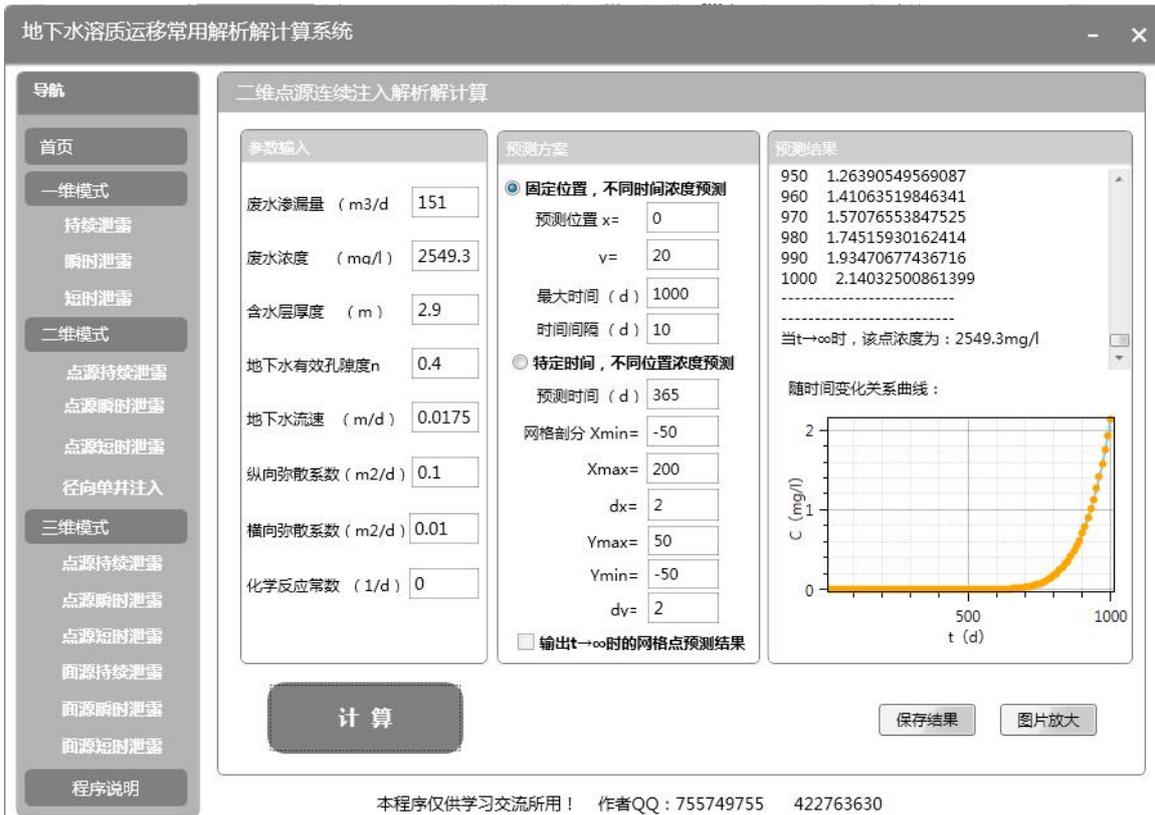
图 5.2-5 沼气池泄露 COD 对地下水影响计算结果 (20m)
