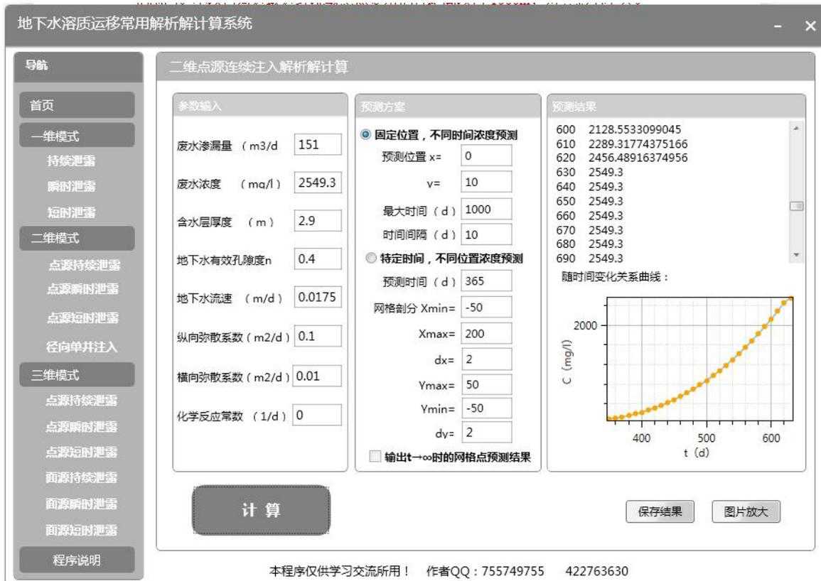
图 5.2-4 沼气池泄露 COD 对地下水影响计算结果 (10m)
